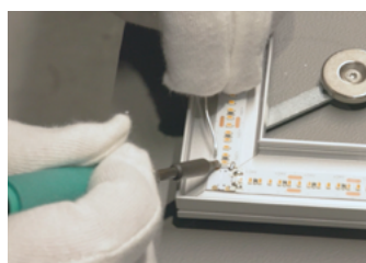
Zusammenführung LED-Flexbänder und Alu-Profile
