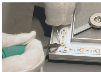
Zusammenführung LED-Flexbänder und Alu-Profile
